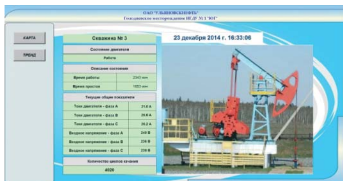
Рис. 4. Пример системы контроля параметров скважины, оборудованной ПШГН
