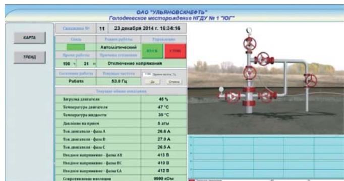
Рис. 3. Пример системы контроля параметров скважины, оборудованной ЭЦН
